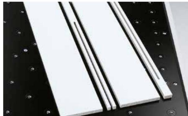
possibile produrre direttamente anche aperture di pannelli e scanalature di inserimento, ad esempio per porte o piani di lavoro.
