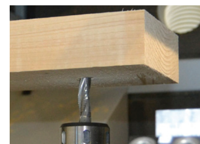
Fraisage de mortaise avec agrégat de fraisage par en dessous
