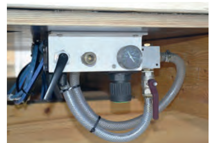
Pneumatik-Set für die zentrale Luftversorgung und Steuerung der C-PowerTec Spannbalken
