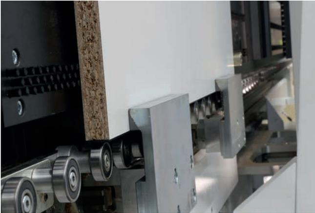
**CNC-gesteuertes Spannangensystem mit 2 Spannanzgen**
