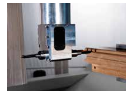
wykonywanie precyzyjnych połączeń narożnikowych na kołki
