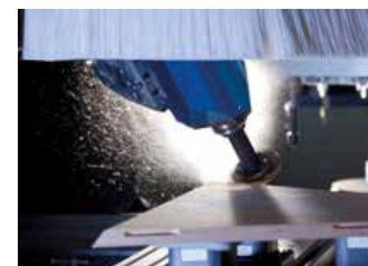
frezowanie skośnych wpustów do łączenia płyt
