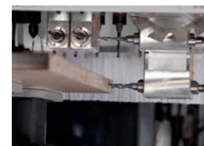
wiercenie otworów w poziomie do łączenia korpusów
