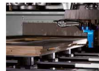
frezowanie kieszeni pod zamki w drzwiach zewnętrznych
