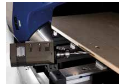
frezowanie kieszeni pod zamki
