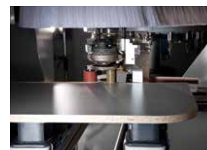
agregat easyEdge do efektywnego oklejania elementów krzywoliniowych
