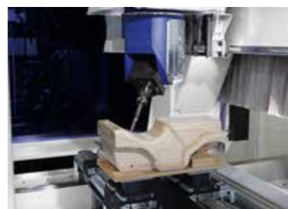
obróbka z interpolacją elementów o dowolnym kształcie
