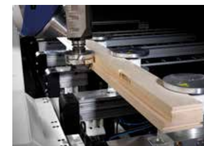
profilowanie elementów ramiakowych
