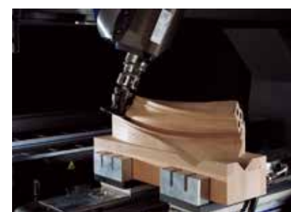
frezowanie poręczy schodów
