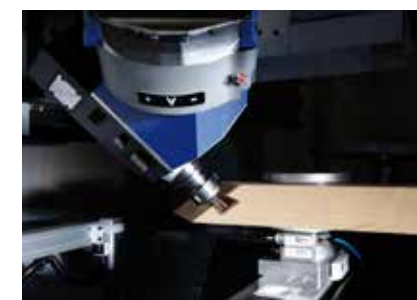
frezowanie połączeń na jaskółczy ogon na belkach pionowych i konstrukcjach ramiakowych
