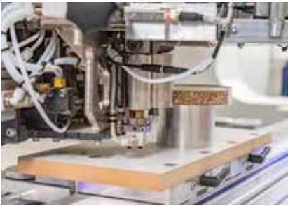
Agregat oklejający powerEdge Pro Duo – agregat spełniający wszystkie wymagania. Technologia oklejania bezspoinowego oraz precyzyjne tastowanie zapewniają idealną jakość podczas oklejania 360°.
