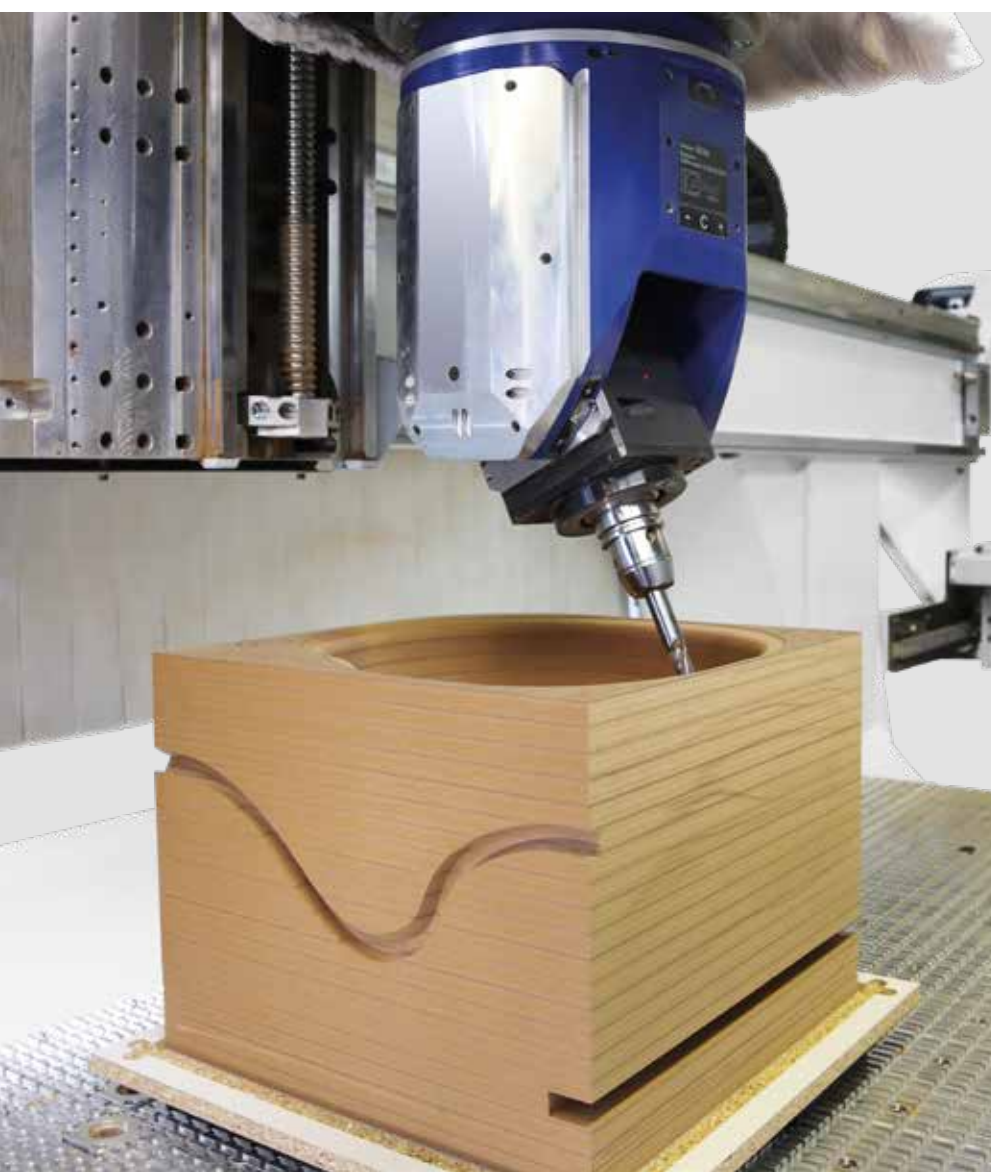
frezowanie elementów o dużej wysokości w osi Z
