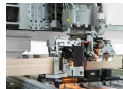
oklejanie wąskich powierzchni elementów o wysokości do 100 mm
