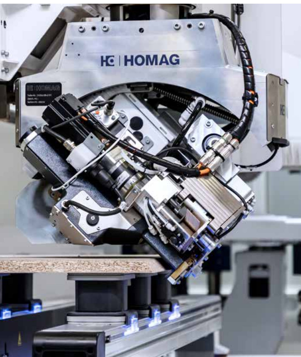
oklejanie obrzeżem skośnych wąskich powierzchni elementu
