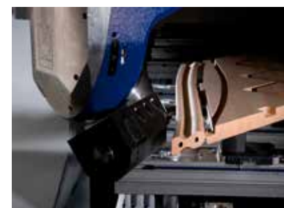
wiercenie otworów pod tralki pod małym kątem
