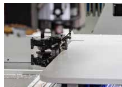
perfekcyjne wykańczanie wąskich powierzchni elementu za pomocą łączonego agregatu wyrównująco-czyszczącego z tastowaniem
