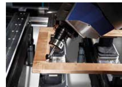
frezowanie wpustów na szybę
