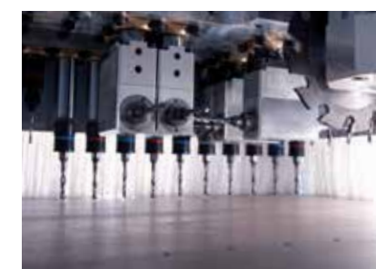
wiercenie w technologii High-Speed z piłą nutującą
