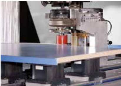
Agregat oklejający easyEdge to uniwersalne rozwiązanie do oklejania małej liczby płyt.
