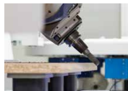
wyrównywanie wystającego obrzeża na profilu postformingowym wraz z tastowaniem
