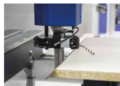
cyklinowanie skośnych wąskich powierzchni elementu
