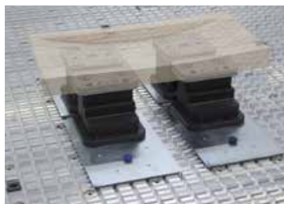
Sistema Maxi-Flex per un posizionamento libero delle ventose a depressione.
