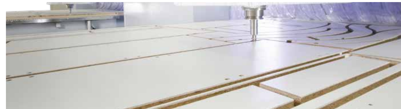
Lavorazione Nesting: taglio e lavorazione dei pezzi all'interno del pannello minimizzando lo scarto
