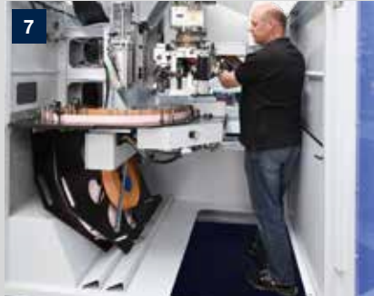
Facile accessibilità – attività come cambio delle punte, service, riempimento di colla e bordi possono essere eseguite comodamente dal lato anteriore della macchina.
