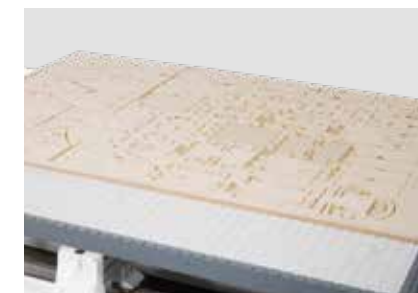
Piano Matrix Il piano Matrix, applicato sopra le ventose, permette di tagliare pezzi sagomati nel modo Nesting.
