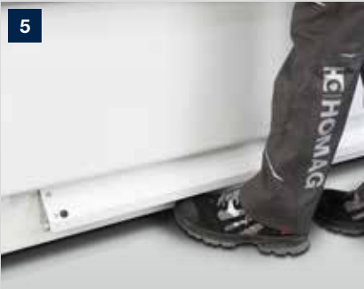
Barra di comando – permette la facile attivazione di registri, barre di sostegno e sistemi di bloccaggio a depressione – senza dover andare alla ricerca del pedale di start.
