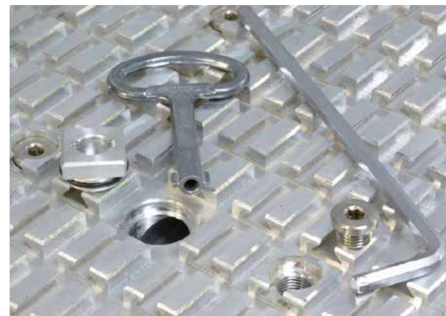
Piastrine di chiusura con filettatura consentono il fissaggio sicuro dei dispositivi di bloccaggio nella guida a coda di rondine.
