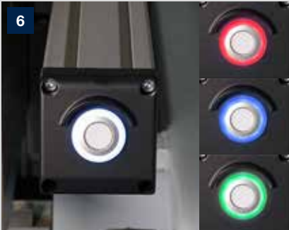
Tasto avvio di programma su entrambi i lati del tavolo macchina. Una spia luminosa indica lo stato del sistema a depressione.
