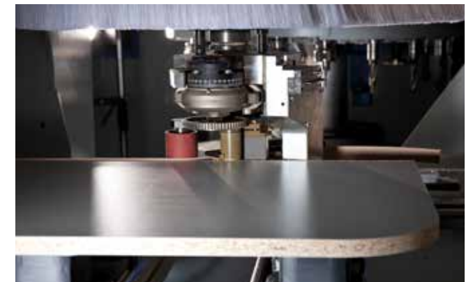
Gruppo di incollaggio easyEdge per l'incollaggio dei bordi su pezzi sagomati
