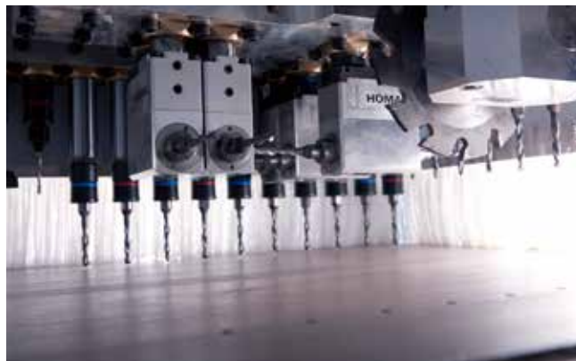
Tecnologia di foratura High-Speed con lama a scanalare
