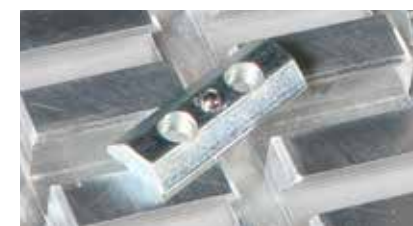
Piastrine di chiusura con filettatura consentono il fissaggio sicuro dei dispositivi di bloccaggio nella guida a coda di rondine.
