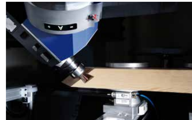
Fresatura di giunzioni tra montanti e traverse
