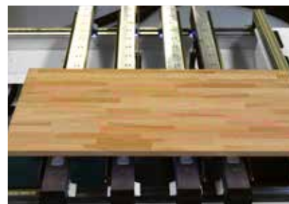
Proiezione con laser dei dispositivi di bloccaggio e del contorno del pezzo per un facile posizionamento dei pezzi grezzi che non possono essere allineati contro i registri.
