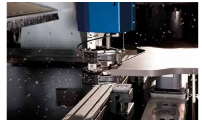
Finitura perfetta dei bordi con il gruppo refilatore/raschiatore combinato con tastatura
