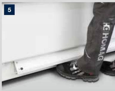
**5 Regleta de conmutación en lugar de interruptores de pedal:** no es necesario buscar ni desplazar el interruptor de pedal. Los topes, los rieles de separación y la sujeción al vacío se pueden activar fácilmente.
