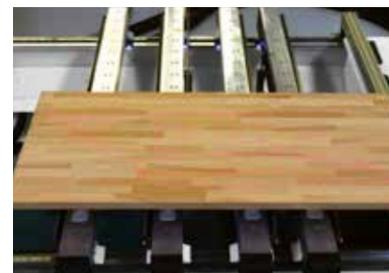
**Proyección láser** de los medios de fijación y del contorno de la pieza para un aprovechamiento óptimo y una colocación sencilla de las piezas en bruto que no se pueden alinear con los topes.
