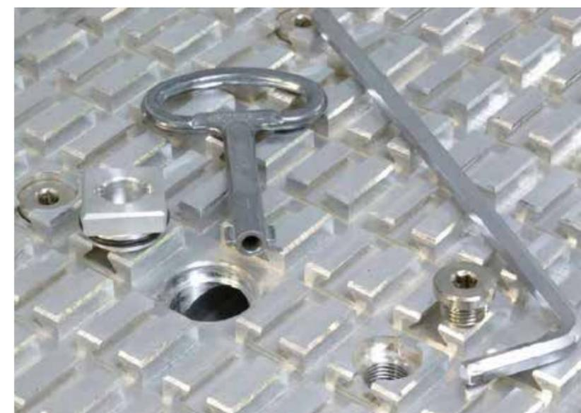
**Conexiones de vacío de 1" con apertura rápida** mediante la llave del armario de distribución y aperturas de vacío con rosca fina para asegurar los medios de fijación
