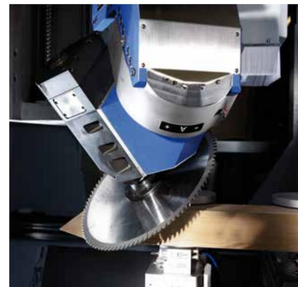
**Husillos de fresado de 5 ejes DRIVE5CS/C+:** con potencia de 10 kW (o de 12 o 15 kW) y una velocidad regulada del husillo de hasta 24 000 rpm para un par de fuerza elevado a velocidades bajas.
