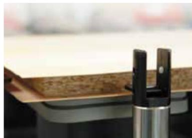
**Perno de tope para saliente de enchapado de recubrimiento** con supervisión de las posiciones finales para proteger las herramientas, los grupos y los operarios.
