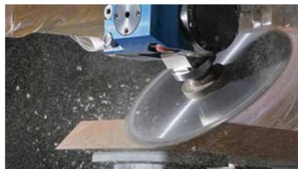
**Serrado, fresado, taladrado en todos los ángulos: grupo FLEX5+** con ajuste de ángulos y cambio de herramienta automáticos. Un grupo excepcional para los husillos de 4 ejes, que cubren el 90 % de las aplicaciones de 5 ejes.
