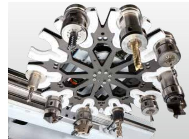
**Cambiador de platos de 10 posiciones** en el husillo de movimiento simultáneo. Cambio de herramienta durante el taladrado o encolado de cantos. Para herramientas y grupos con un diámetro de hasta 180 mm.
