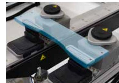
**Multitensor** para el sistema de vacío de doble circuito. Elemento de sujeción por vacío para sujetar listones y piezas individuales de la ventana.
