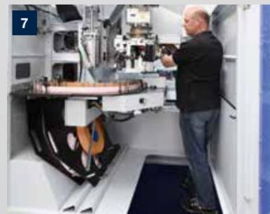
**7 Fácil acceso:** algunas acciones como el cambio de broca, el servicio, el llenado de adhesivo y el cambio de cantos se pueden realizar cómodamente desde la parte delantera de la máquina.
