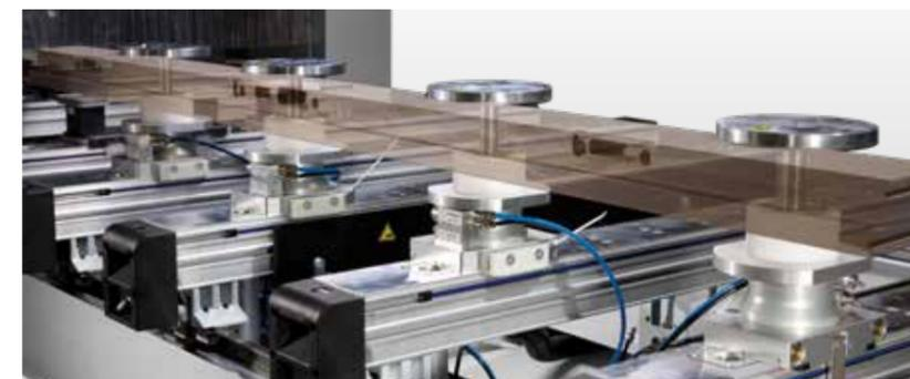
**powerClamp:** dispositivo de sujeción manual para piezas rectas y curvadas. Ideal para las partes del bastidor, así como las piezas estrechas y acodadas.
