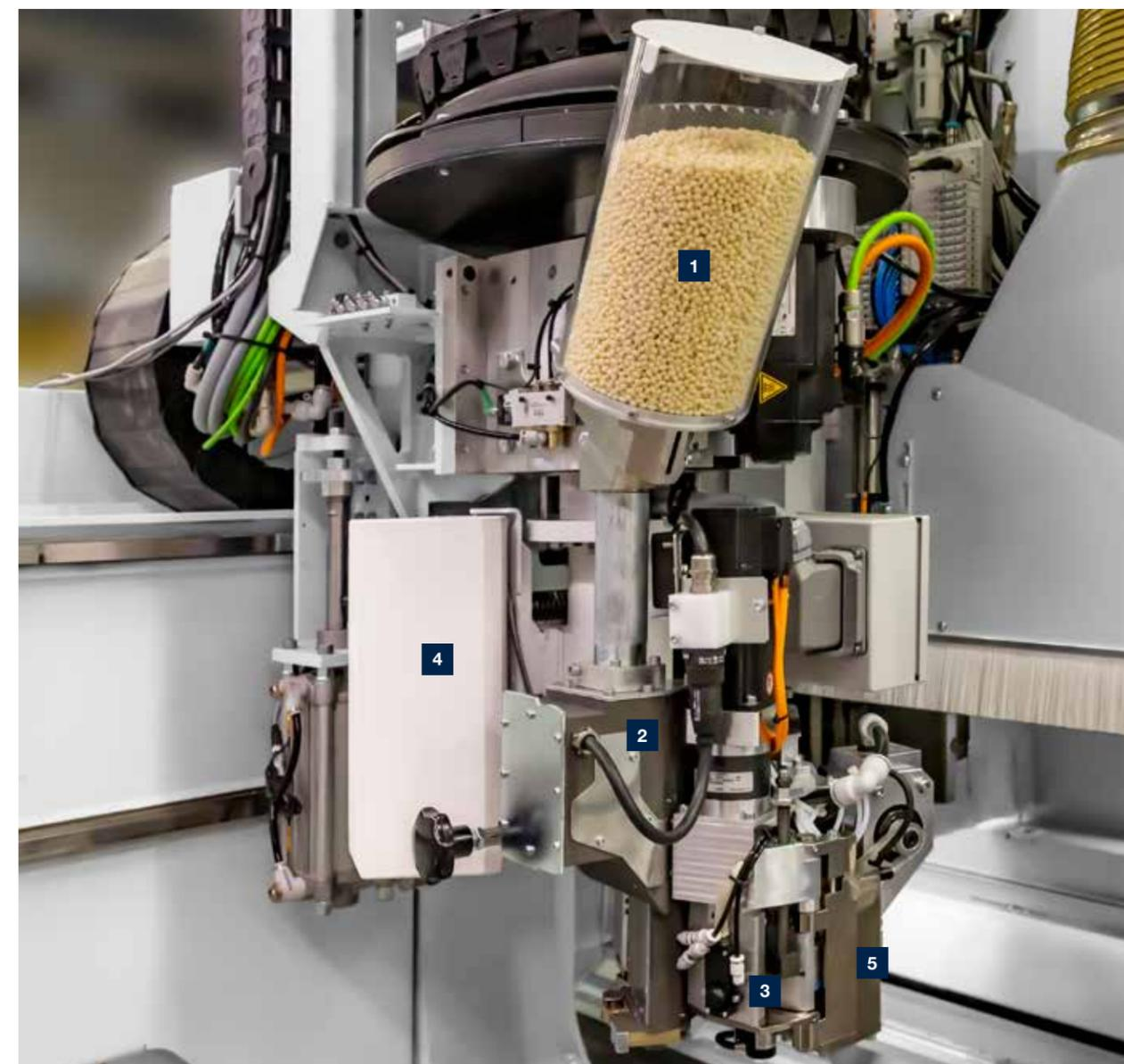
**1 Depósito de granulado:** El depósito de granulado se puede aflojar con un cierre de bayoneta y retirarse de la máquina. Esto permite un cambio rápido y sencillo del color de la cola. De forma alternativa, también se pueden introducir pequeñas cantidades directamente en la unidad de aplicación.
