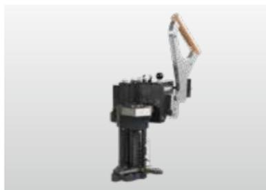
**Unidad de aplicación adicional** para un cambio rápido entre los distintos tipos de cola. Opcional con revestimiento antiadherente para el llenado manual con PU.
