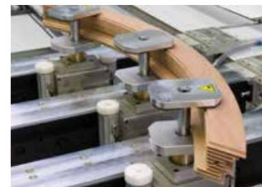
**Tensor de 3 niveles:** tensores de gran rigidez de 3 niveles con una gran altura de sujeción para un mecanizado completo y preciso de piezas de ventanas y puertas sin necesidad de moldeado y perfilado posterior.
