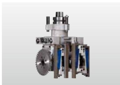
**Grupo combinado** de corte/redondeo de esquinas. Para un corte a medida de exploración de los extremos salientes del canto y un redondeo de esquinas preciso de los cantos.
