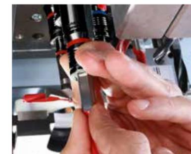
**Sistema de cambio rápido** para un cambio de broca sin herramientas y reducción de los tiempos de preparación.
