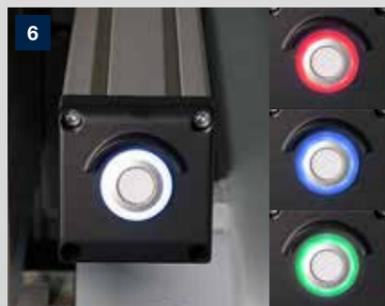
**6 Botón para iniciar el programa** directamente en el perfil de tope izquierdo y derecho de la mesa de la máquina. Gracias a los indicadores luminosos a color se puede ver rápidamente el estado de sujeción.
