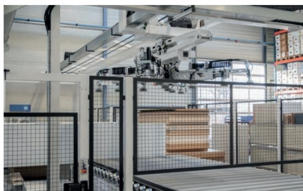
La **conexión de máquinas de mecanizado** prescinde de interfaces normalizadas. Ya se tenga que colocar directamente sobre una sierra o se conecte una máquina de mecanizado mediante una vía de rodillos con el almacén, los sistemas STORETEQ P-300/P-500 se encargan de ofrecer un óptimo valor añadido de las máquinas de mecanizado conectadas.
