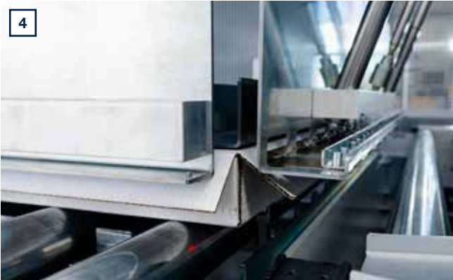
Pressage de la languette longitudinale et de la languette transversale avant : les languettes longitudinale et transversale avant sont collées sur le carton par des éléments de pressage situés au-dessus.
