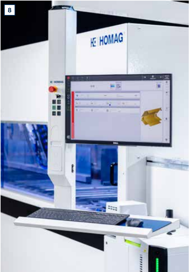
Le terminal de commande est monté directement sur la machine via le bras pivotant, au choix à gauche ou à droite. Commande intuitive de la machine à l'aide du logiciel intelliCut.
