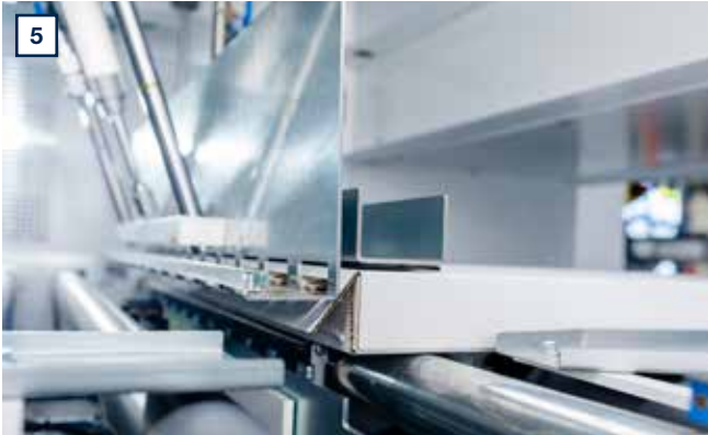
Application de colle et pressage de la languette transversale arrière : les paquets sont arrêtés sur le bord arrière. Ensuite, la colle est appliquée et la languette transversale arrière est fermée.
