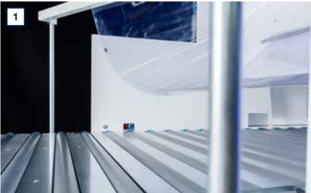
Einlaufstrecke vor Verschlussraum - zum Transport der noch offenen Kartons. Der senkrecht stehende Deckel wird umgeklappt.
