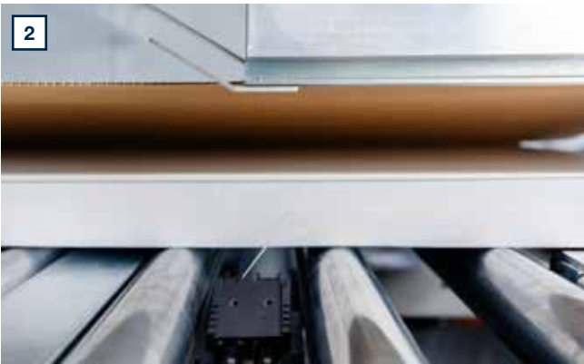
Leimauftrag längsseitig - im Durchlauf werden auf die Längsseite des Kartons, in Abhängigkeit der Kartenhöhe, 1 oder 2 Spuren Schmelzkleber aufgetragen.
