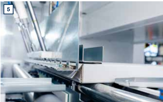
Leimauftrag und Anpressen der hinteren Querlasche - Pakete werden auf Hinterkante gestoppt. Anschließend erfolgt der Leimauftrag und das Verschließen der hinteren Querlasche.
