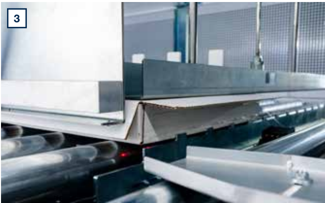
Leimauftrag vordere Querseite - die Pakete werden über die Vorderkante positioniert und gestoppt. Mit einer verfahrbaren Düse wird der Schmelzkleber auf die vordere Querseite aufgetragen.
