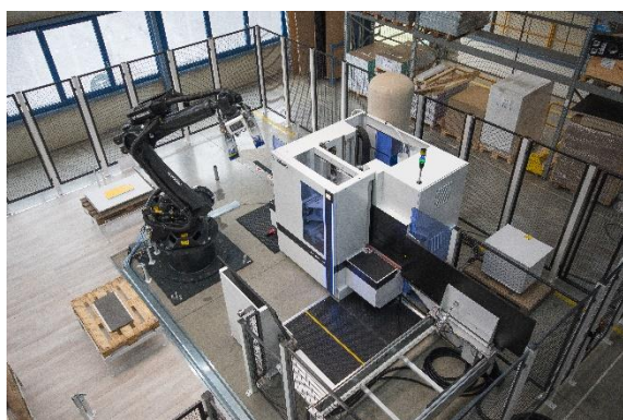
画像 1: DRILLTEQ V-500 と FEEDBOT D-300 の組み合わせにより、効率的な製造を可能にする生産セルが形成されます。
