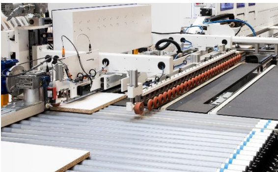
画像 4: EDGETEQ S-500 に新たに取り付けられた部材送りシステム WZ14。
