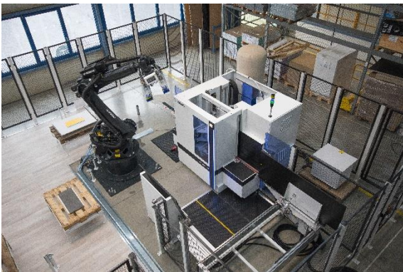
Figura 1: DRILLTEQ V-500 e FEEDBOT D-300 formano in combinazione un'isola di produzione efficiente.
