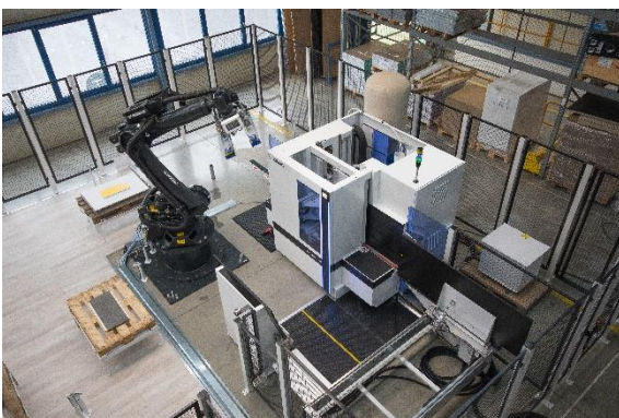
Imagen 1: la DRILLTEQ V-500 y la FEEDBOT D-300 forman, en conjunto, una celda de producción eficiente.
