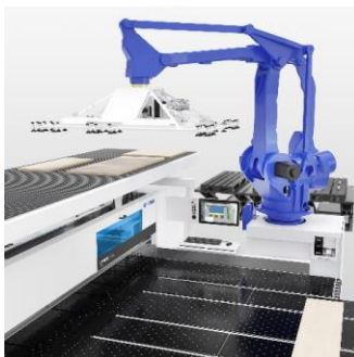
Imagen 7: SAWTEQ B-300 flexTec. La sierra puede manejarse manualmente, aunque también permite un corte de a medida totalmente automático gracias al robot integrado.
