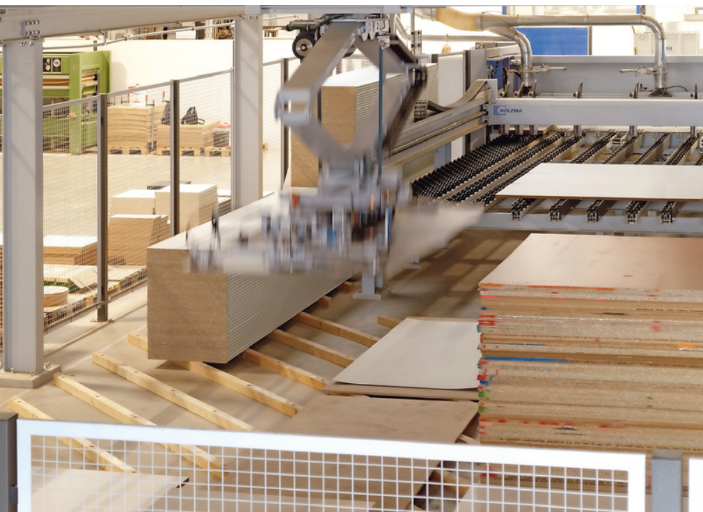
Emsig sorgt die Traverse dafür, dass die Säge fast niemals warten muss. Auf 22 Stapeln liegt hier nicht sehr viel mehr als eine Tagesproduktion. Täglich kommt Plattennachschub
