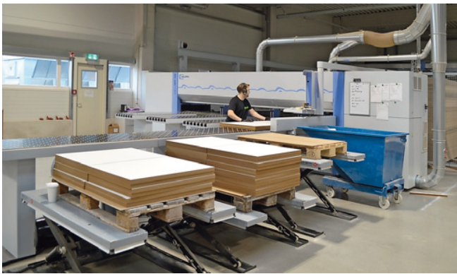
Hinter dem Luftkissentisch befinden sich Hubtische, die die Stapelhöhe stets knapp unter dem Tischniveau halten
