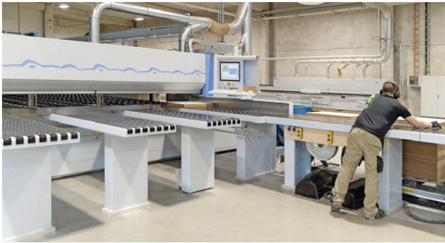
Die fertigen Zuschnitte muss er nicht heben und tragen, sondern nur auf den passenden Stapel schieben
