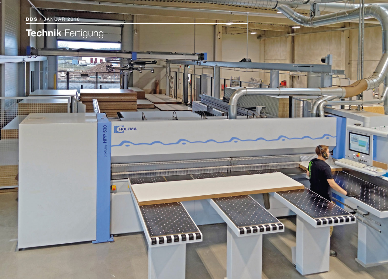
Während Clemens Simon bei Popp vorne ein Plattenpaket zuschneidet, legt das Lager hinten das nächste Paket auf
