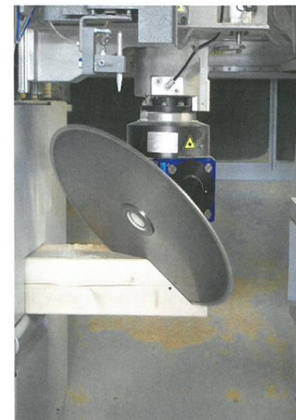
Die Kerne des Seilhiebs werden an allen vier Bauteilseiten mit dem Sägeaggregat hergestellt.
