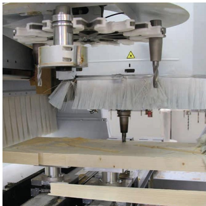
▲ Maschine ist mit einem an der Hauptspindel mitfahrenden 10-fach-Wechsler ausgestattet (Bilder: Christina Wegner)
