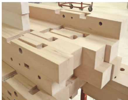
Auch die Pfosten sind nun alle in der Regel von zwei oder drei Seiten gefräst und gebohrt
