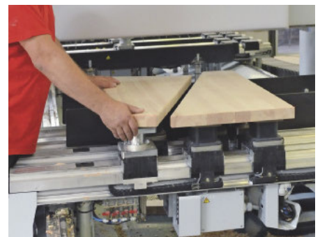
Das fertig bearbeitete Stufenpaar ist aus einer rechteckigen Platte entstanden
