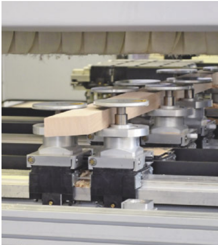
Umspannen des Handlaufs nachdem die linke Seite bearbeitet worden ist
