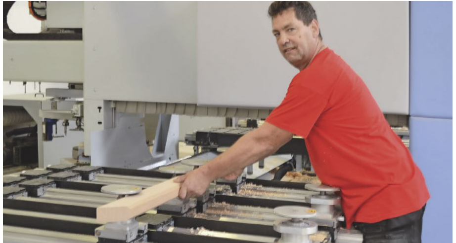
Günter Härrer entnimmt den soeben fertiggestellten Handlauf. Anders als bei der Vorgängermaschine fallen außer dem Endschliff keine Nacharbeiten an
