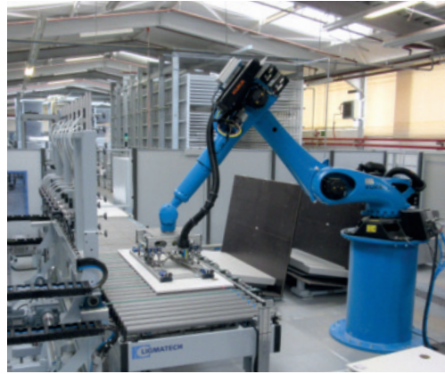
>Links: Die Roboterzelle wird vorwiegend für aufwendige Fräs- und Bohrarbeiten an Tischplatten eingesetzt und entlastet dadurch die Weeke-Bohrstraße.
