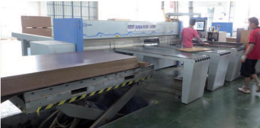
**>Zeitgleicher Start: Bei Aufträgen mit Teilen in den Hauptfarben werden alle Sägen mit der gleichen Farbe bzw. dem gleichen Dekor zum identischen Zeitpunkt mit jeweils 20 optimierten Aufträgen gestartet.**
