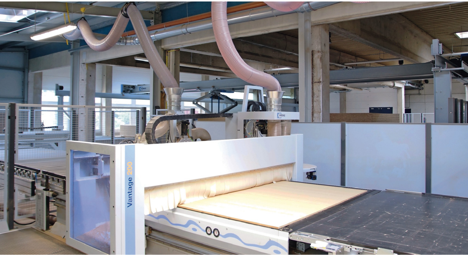
Der Messebauer Maedebach hat seine Zuschnittzelle von Weeke um diese Nestingmaschine erweitert
