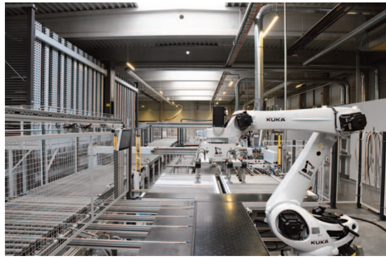
► Die Bekantung mit Umlauf ist mit zwei Robotern am Ein- und Auslauf automatisiert.
