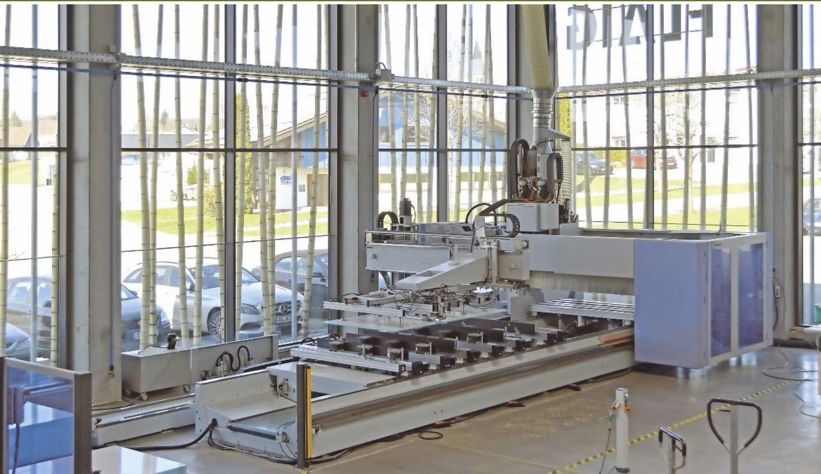
Einfache, flächige Möbelteile oder auch große Saunawände arbeitet sie bei Flaig im Werk II ganz autark ab: die BMG 611 von Homag
