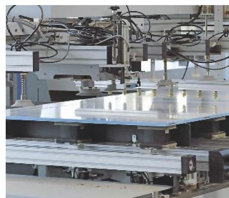
Der von der CNC angesteuerte Beschicker bläst den Staub aus den Bohrlöchern
