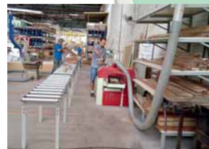
Die Produktion nach der Umstellung: Erhöhte Rollenbahnen ermöglichen einfacheres, ergonomisches Arbeiten. Auch der Materialtransport wird dadurch vereinfacht
