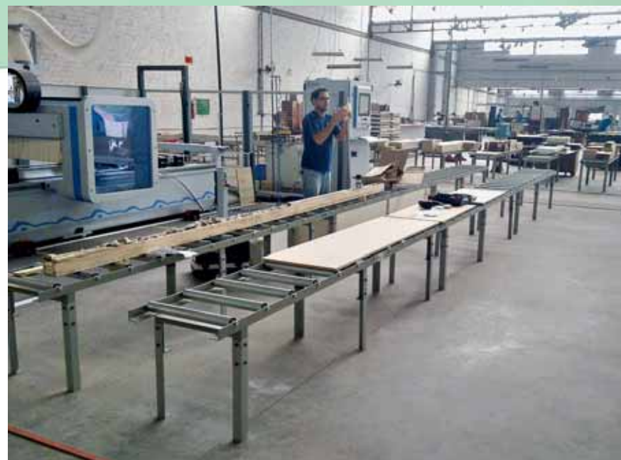
Die Produktion nach der Umstellung: Erhöhte Rollenbahnen ermöglichen einfacheres, ergonomisches Arbeiten. Auch der Materialtransport wird dadurch vereinfacht
