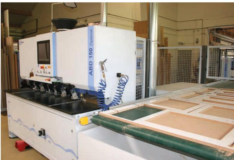
◀ Die Weeke ABD 150 CNC Stationärmachine zum horizontalen Bohren und Dübeln befindet sich unmittelbar neben der Nesting-Maschine
