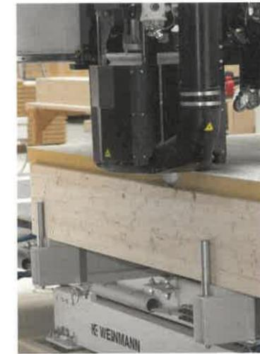
➤ Absägen der Überstände der Holzfaserdämmung durch die Multifunktionsbrücke
