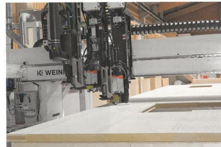
➤ Die Wallteq M-340 befestigt die Holzfaserdämmung mit Klammern
