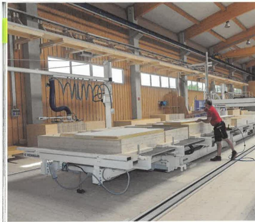
➤ Auflegen der Holzfaserdämmung auf eine 360 mm starke Holzrippenkonstruktion
