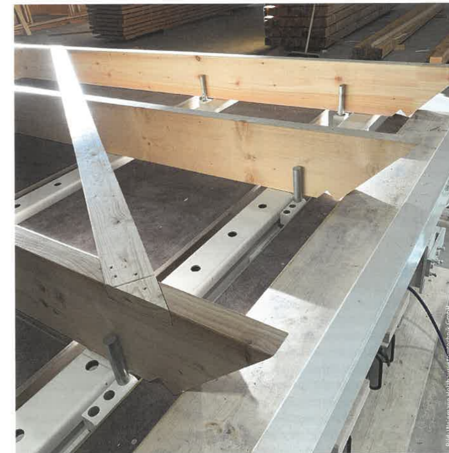
Einer der Selbstbautische ist mit Dach-Decken-Spannern ausgestattet, mit denen der Herstellprozess von Dach- und Deckenelementen vereinfacht werden soll.
