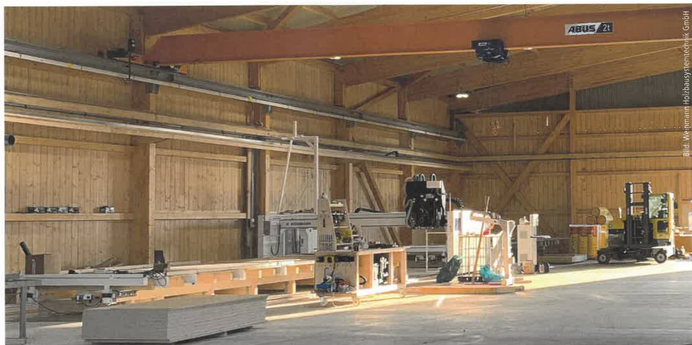
Die Zimmermeisterbrücke ermöglicht eine gewisse Automatisierung auch bei kleineren Stückzahlen.
